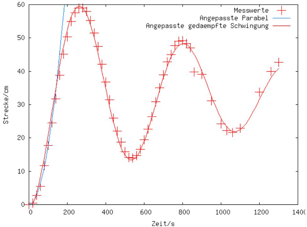
Abbildung 2: Position des Laserpunktes als Funktion der Messzeit
