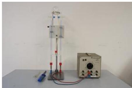
Dieses Glasgefäß wird in einem dafür vorgesehenen Drahtring abgelegt. Die beiden senkrechten Rohre sind oben offen, können aber jeweils mit einem Ventil geschlossen werden.
