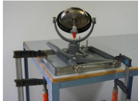
Dasselbe kann auch mit horizontaler Kreiselscheibe durch Kippen der Apparatur demonstriert werden. Die technische Anwendung ist in diesem Fall der Kreiselhorizont in Flugzeugen, welcher die Neigung des Flugzeuges relativ zur Horizontalen misst.
