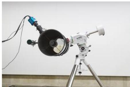
Das Teleskop besitzt einen parabolischen Hauptspiegel mit einer Öffnung von 254mm und einer Brennweite von 1016mm, d.h. das Öffnungsverhältnis (Spiegeldurchmesser/Brennweite) beträgt 1:4. Ein großer Fangspiegel führt zu einer guten Ausleuchtung des Bildfeldes. Die Tubuslänge beträgt 980mm. Laut Hersteller wird ein Auflösungsvermögen von 0,46 Bogensekunden erreicht.
