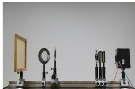
In einiger Entfernung befindet sich eine weitere Kreisblende auf einem Positionssteller sowie eine Sammellinse (Brennweite z.B. +130mm), welche den Lichtpunkt auf einen Schirm abbildet.
