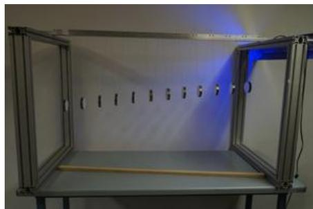
Mit dem beiliegenden Holzstab bringt man die Pendel zunächst zur Ruhe und lenkt sie dann synchron möglichst gleichmäßig mit nicht zu kleiner Amplitude aus. Durch die unterschiedlichen Schwingungsdauern ergeben sich interessante Muster und Effekte (Schlangenlinien, gegenphasige Schwingung in Reihen, etc.), insbesondere wenn man von vorne leicht von oben darauf schaut. Nach einiger Zeit schwingen die Pendel wieder in Phase, danach beginnt das Spiel von neuem.
