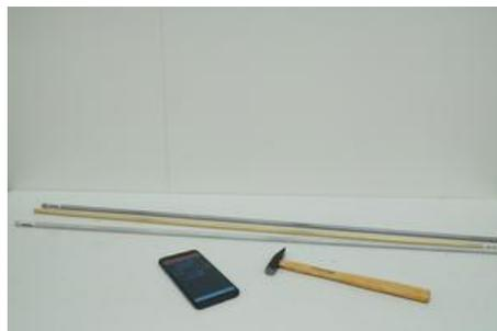
An der gehaltenen Stelle befindet sich ein Knoten, an den Stabenden haben wir offene Enden. Wenn man den Stab in der Mitte hält, hört man den Grundton ( $L/2 = \lambda$ ). Hält man in bei einem Viertel der Stablänge, kann man die erste Oberschwingung anregen ( $L = \lambda$ ). Die Schallgeschwindigkeit ergibt sich aus der gemessenen Frequenz als  $v = \lambda \cdot f$ . Literaturwerte sind hier zu finden. Unter "Resultat" ist ein Excel-Datei mit Messergebnissen verlinkt.
