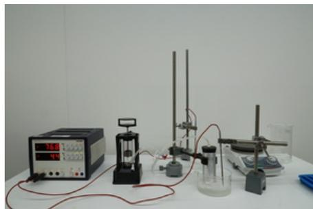
Angeschafft wurde das Gerät zur Veranschaulichung des Stirling-Prozesses, welcher mit dem üblichen Versuchsaufbau sehr schnell vor sich geht. Hier kann die Bewegung des Arbeitskolbens durch isotherme Expansion und Kompression beobachtet werden. Die isochoren Phasen kann man dagegen nicht explizit sehen. Man verwendet die direkte Schlauchverbindung, ohne die speziellen Ventile.
